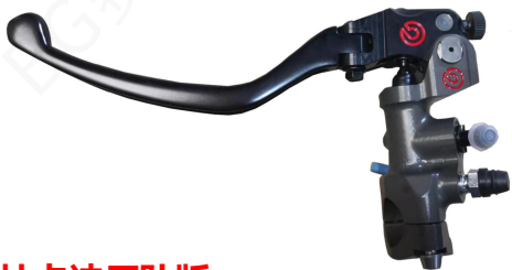
MotoGP 离合手泵 (锻造CNC-钛活塞)
