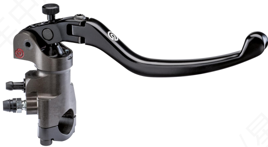
PR CNC 刹车手泵 (锻造CNC-专业赛道)
